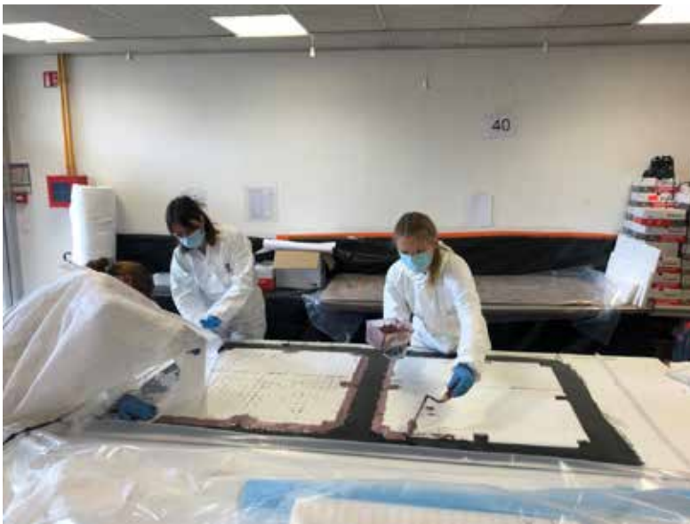
Stratification avec mise sous vide de composite carbone époxy
