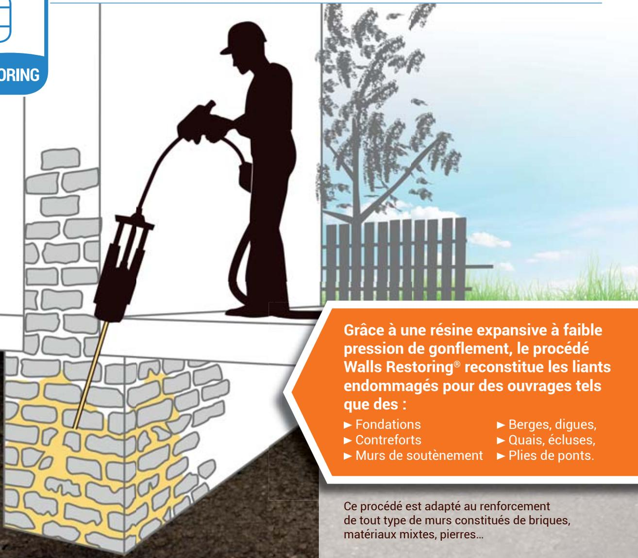
Grâce à une résine expansive à faible pression de gonflement, le procédé Walls Restoring® reconstitue les liants endommagés pour des ouvrages tels que des :
