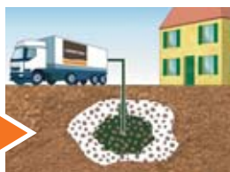
Injection de la résine expansive et diffusion entre les billes d'argile
