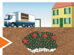
Clavage et mise en compression du toit de la cavité
