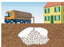
Comblement avec des billes d'argile expansée
