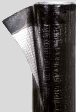
**Sopralène Flam® 180 Alu Coloré** est une membrane d'étanchéité à base de bitume élastomère SBS et d'une armature en polyester non tissé de 180 g/m<sup>2</sup> et dont la face supérieure aluminium blanche est réfléchive. Cette membrane se pose par soudure à la flamme comme couche de protection dans un système d'étanchéité bitumineux SBS.
