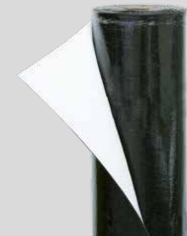
**Soprastar® Flam** est une membrane d'étanchéité à base de bitume élastomère à armature composite de polyester dont la face inférieure est protégée par un film thermofusible et dont la face supérieure blanche est réfléchive, grâce à un revêtement quadricouche laminé croisé spécifique et exclusif.
